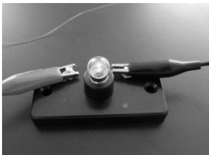
ニクロム線(測定結果 2.8V・189mA)
